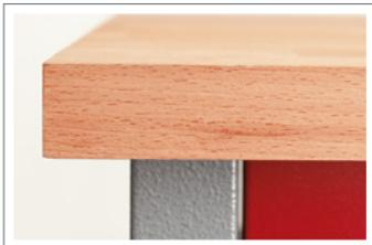
Massive Buchenplatte, 30 mm stark, stabverleimt und keilgezinkt, Öl-behandelt zur Abweisung von Schmutz und zum Schutz vor Verzug.
