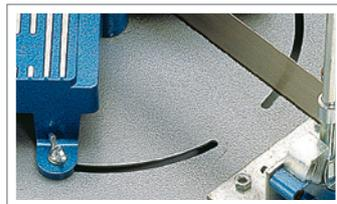
Winkel mit Feststellmutter stufenlos verstellbar: vertikal bzw. horizontal 45°/90°/45°
